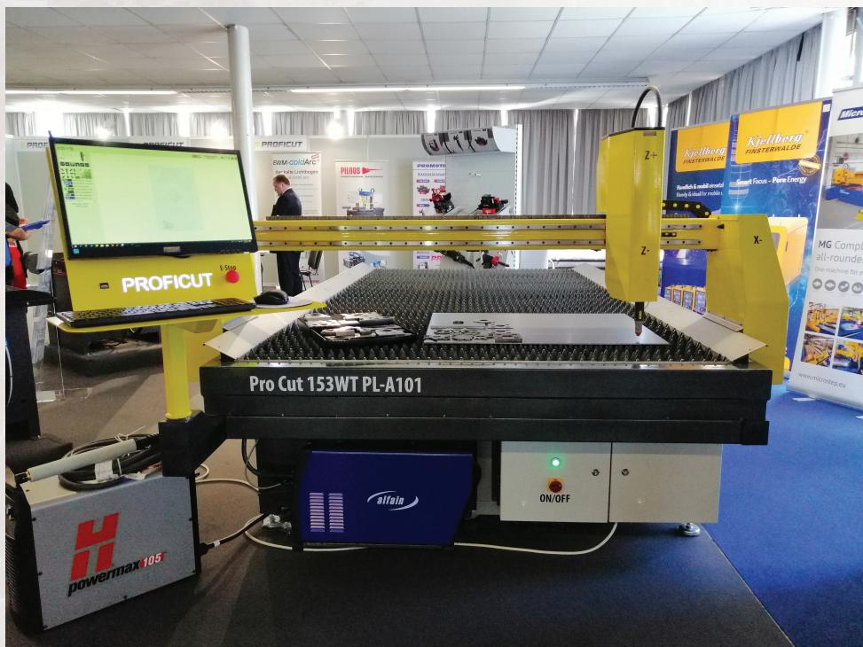
Uz mašinu standardno se dobija izvor plazme **Alfalin Pegas 101** od 100A (Češka Republika), dok uz doplatu može da se izabere i **Hypertherm Powermax 105** (USA). Postoji mogućnost po zahtevu klijenta i uz korekciju cene ugradnja slabijih i jačih modela plazmi proizvođača Alfalin i Hypertherm, od 45 do 125A. Za ozbiljnije aplikacije sečenja pružamo mogućnost uz doplatu ugradnje vodeno hlađene plazme **Hypertherm MAXPRO200**, od 200A i sečenja do debljine do 50mm.
